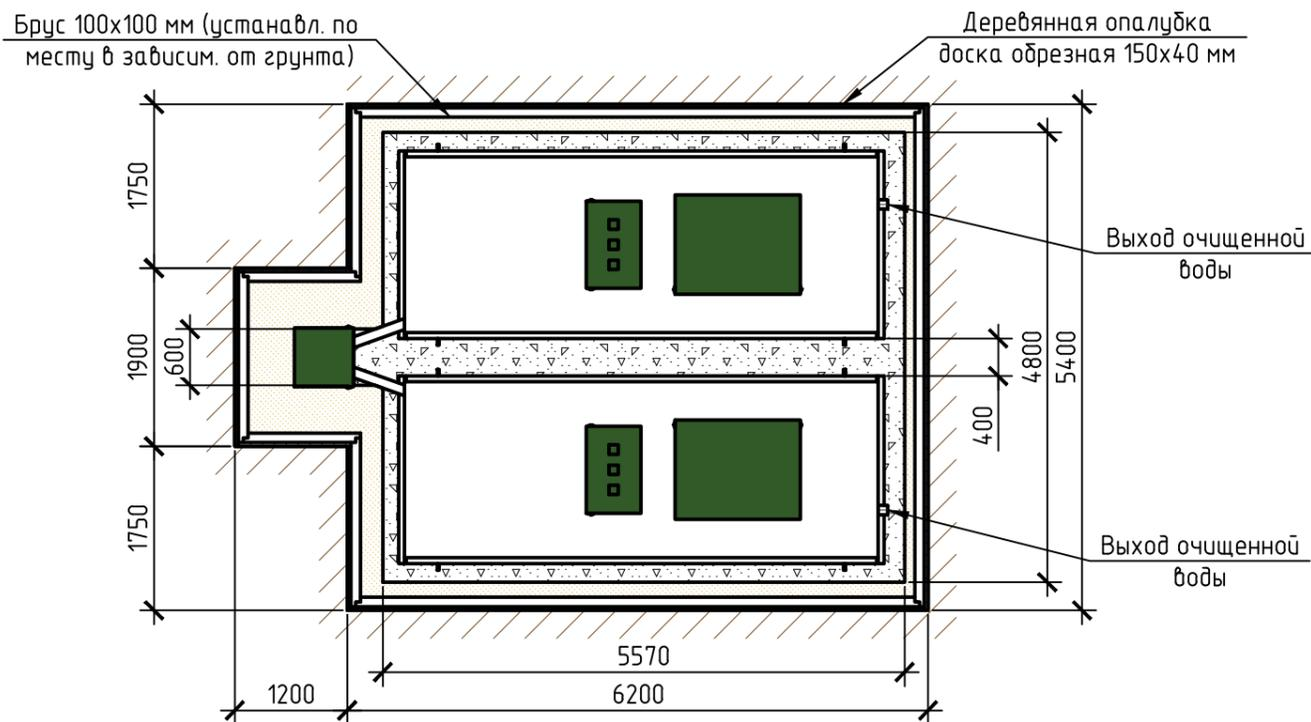
Два модуля устанавливаются на одном горизонтальном уровне относительно друг друга.
